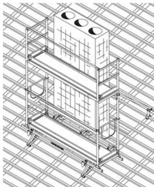
In Verbindung mit dem ALTRAD BAUMANN Dachständer und dem Aufstockrahmen mit Zubehör, erhalten Sie eine vollwertige Dacharbeitsbühne bis zu einer Standhöhe von 4 Metern.
